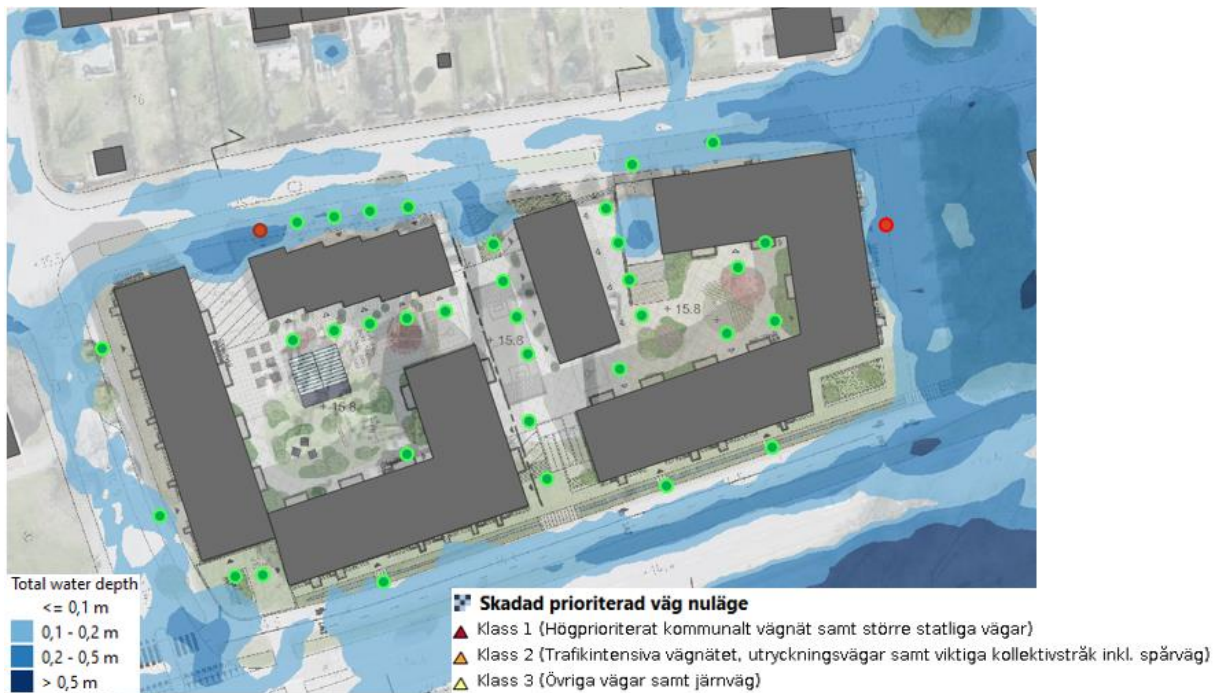
Figur 24: Byggnaders framkomlighet enligt TTÖP. Röda punkter visar entréer som bedöms oframkomliga (över 20 cm vatten framför entrén) och gröna punkter visar entréer som bedöms framkomliga vid skyfall.
